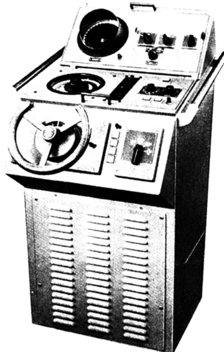
Σχ. 8.8β. Η μονάδα ελέγχου γέφυρας.
