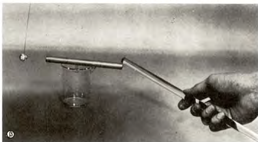
Σχήμα 11-3 Επαναλαμβάνουμε το πείραμα με γυάλινη ράβδο αντί της μεταλλικής. Η μπάλα παραμένει σε επαφή με τη γυάλινη ράβδο.
