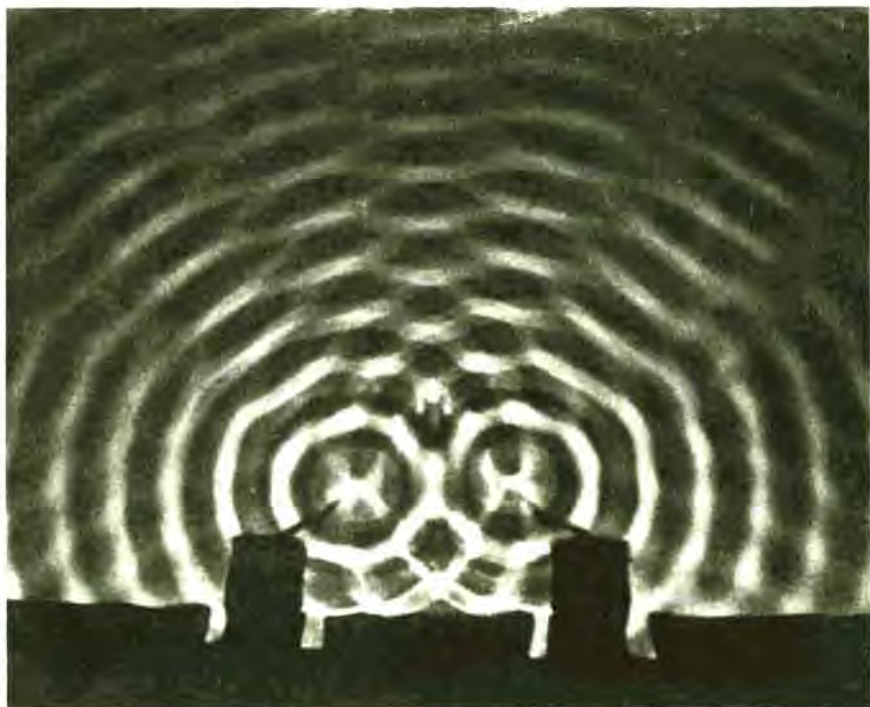
Σχήμα 24-9 Εικόνα συμβολής από δυο πηγές όπως στην εικόνα του σχήματος 24-6 αλλά με μεγαλύτερο μήκος κύματος.
