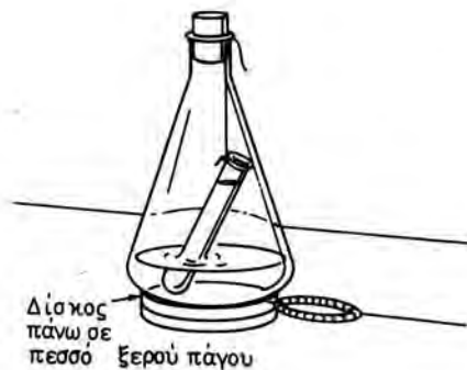
Σχήμα 2-12 Εικόνα ενός πειράματος που δείχνει ότι η μάζα αδράνειας δεν αλλάζει κατά τις χημικές αντιδράσεις.
