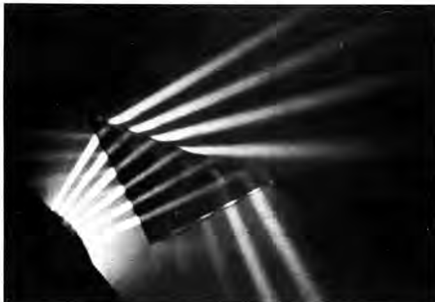
Σχήμα 18-21 Λεπτές φωτεινές δέσμες που εισέρχονται σε ένα γυάλινο πρίσμα από κάτω αριστερά. Οι δυο δέσμες που εισέρχονται πλησιέστερα προς τη βάση του πρίσματος ανακλώνται ολικά στην οριζόντια επιφάνεια γυαλιού-αέρα. Οι άλλες τέσσερις δέσμες ανακλώνται μερικώς σε αυτήν την επιφάνεια.
