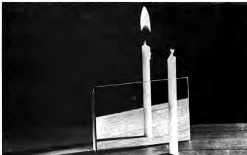
Σχήμα 19-7 Θέση του φανταστικού ειδώλου. Αυτό το πείραμα επαληθεύει τους υπολογισμούς που βασίζονται στους νόμους της ανακλάσεως.
