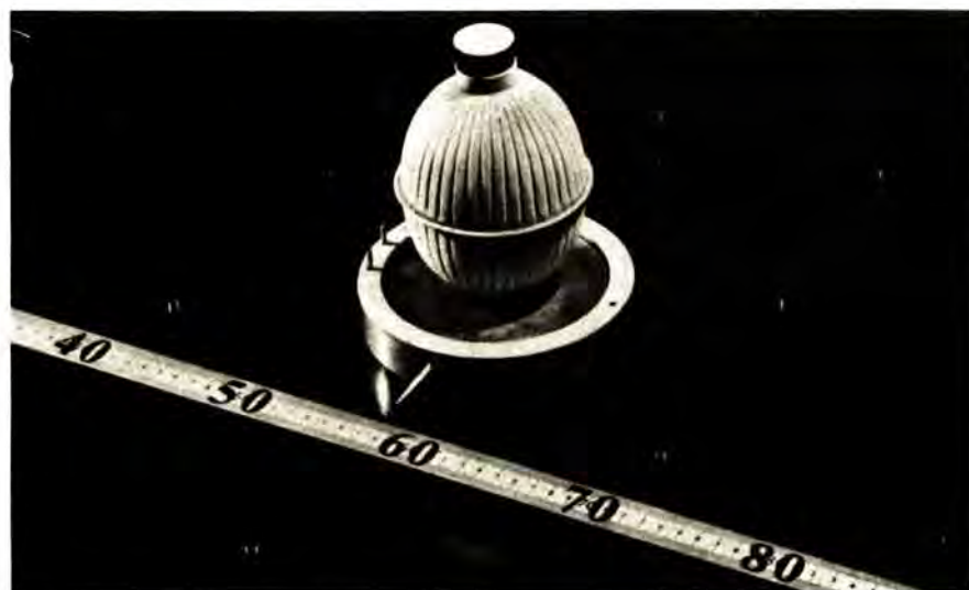
Σχήμα 2-5 Η κίνηση του πεσσοῦ ξεροῦ πάγου. Κινήθηκε ἀπὸ τὰ ἀριστερὰ πρὸς τὰ δεξιὰ ἐνὼ φωτιζόταν με λάμπες 24 φορές σε 10 s ἢ κάθε 0,42 s. Ἡ κλίμακα ἀπὸ κάτω εἶναι σε εκατοστόμετρα. Αὐτὴ εἶναι μίᾳ καλῇ προσέγγισις στὴν ἰδανικὴ περίπτωσις κινήσεως χωρὶς δύναμη. Ὁ πεσσὸς κάνει σχεδὸν σταθερὰ μετατοπίσεις σε ἴσα χρονικὰ διαστήματα.
