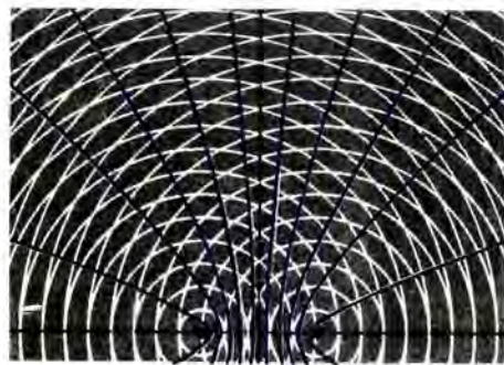
Σχήμα 24-8 Δεσμικές γραμμές από δυο πηγές. Μεταξύ των δεσμικών γραμμών βρίσκονται κινούμενες ενισχυμένες (επί δύο) κορυφές και κινούμενες ενισχυμένες (επί δύο) κοιλάδες.
