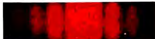
Σχήμα 25-3 (δ) Η εικόνα αυτή έχει παραχθεί με κόκκινο φως και την ίδια διάταξη όπως στο σχήμα 25-3 (γ). Και οι δυο εικόνες ονομάζονται εικόνες περιθλάσεως.
