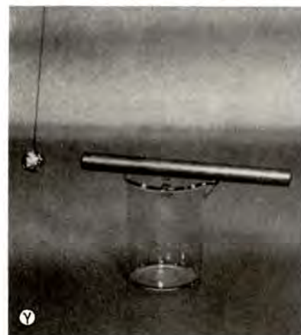
Σχήμα 11-3 Επαναλαμβάνουμε το πείραμα με γυάλινη ράβδο αντί της μεταλλικής. Η μπάλα παραμένει σε επαφή με τη γυάλινη ράβδο.
