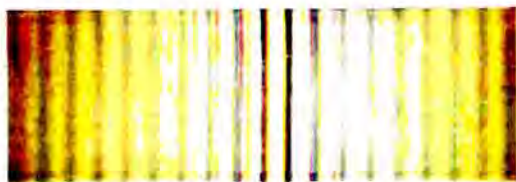
Σχήμα 25-3 (α) Εικόνα συμβολής που παράγεται όταν λευκό φως περνά από δυο στενές σχισμές.
