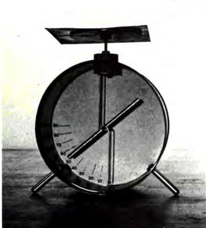
Σχήμα 20-6 (α) Το ίδιο ηλεκτροσκόπιο όπως στο σχήμα 20-5 είναι φορτισμένο θετικά.
