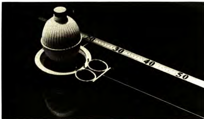
Σχήμα 2-11 Ο πεσσός που χρησιμοποιήθηκε στο πρώτο πείραμα επιταχύνεται με δύναμη διπλάσια από την προηγούμενη. Το χρονικό διάστημα μεταξύ φωτεινών λάμψεων ήταν πάλι 0,42 s.
