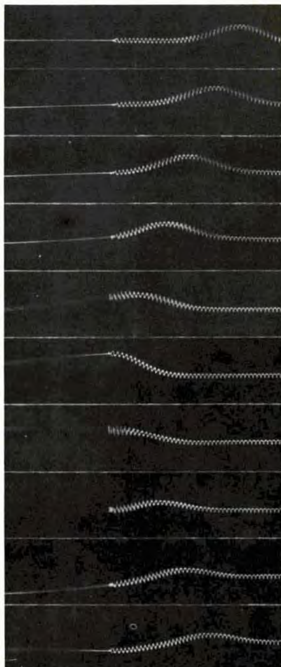
Σχήμα 22-13 Ο παλμός σε ένα ελατήριο που ανακλάται στο σημείο ζεύξης με ένα πολύ λεπτό νήμα. Ολόκληρος ο παλμός επιστρέφει κανονικά. Η ασάφεια της εικόνας του νήματος στις μεσαίες φωτογραφίες δείχνει ότι τα σωματίδια του νήματος κινούνται με μεγάλη ταχύτητα καθώς περνά ο παλμός. Μπορείτε να προσδιορίσετε την κατεύθυνση αυτής της κινήσεως σε κάθε ένα από τα σχήματα;
