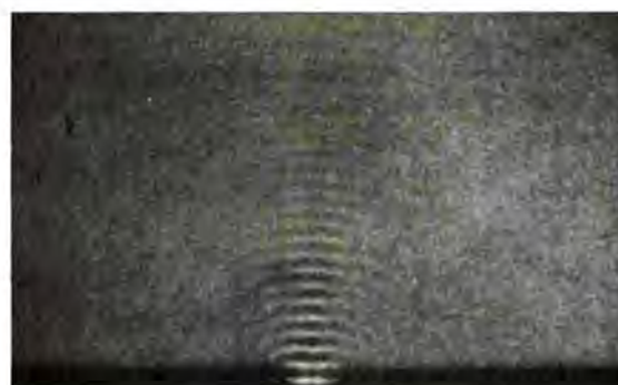
Σχήμα 23-21 Τρεις εικόνες κυμάτων που περνούν μέσα από το ίδιο άνοιγμα. Προσέξτε τη μείωση στην καμπύλωση των μικροτέρων μηκών κύματος.
