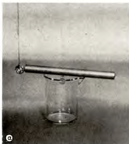
Σχήμα 11-3 Επαναλαμβάνουμε το πείραμα με γυάλινη ράβδο αντί της μεταλλικής. Η μπάλα παραμένει σε επαφή με τη γυάλινη ράβδο.
