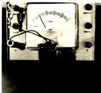
Σχήμα 12-3 Ενδείξεις βολτομέτρου για μπαταρίες με διάφορους αριθμούς στοιχείων.
