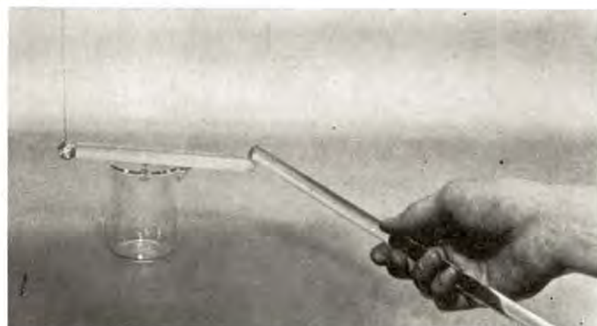
Σχήμα 11-3 Επαναλαμβάνουμε το πείραμα με γυάλινη ράβδο αντί της μεταλλικής. Η μπάλα παραμένει σε επαφή με τη γυάλινη ράβδο.
