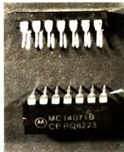
Σχήμα 13-19 Φωτογραφία σε μεγέθυνση ενός ολοκληρωμένου κυκλώματος που περιλαμβάνει τέσσερις πύλες Ex-OR. Ένας κατάλογος των καθιερωμένων συμβολισμών για λογικές πύλες και IC περιλαμβάνεται στον οδηγό του εργαστηρίου.
