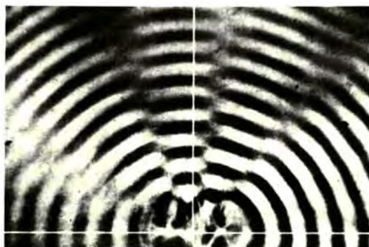
Σχήμα 24-17 Η συμβολή από δυο σημειακές πηγές με διαφορετικές καθυστερήσεις φάσεως p της δεξιάς πηγής. Στην επάνω φωτογραφία οι πηγές είναι σε φάση p = 0 . Στις επόμενες φωτογραφίες το p αυξάνεται και έχει την τιμή p = 1/2 στην τρίτη φωτογραφία.
