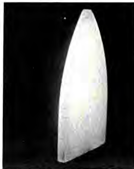
Σχήμα 20-3 Φωτογραφία ενός σίδερου σιδερώματος παρμένη σε σκοτεινό δωμάτιο. Το μόνο φως ήταν η υπέρυθρη ακτινοβολία που ανέδιδε το ίδιο το σίδερο.
