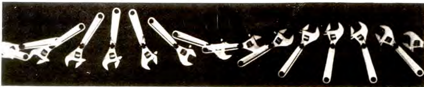
Σχήμα 6-17 Φωτογραφία πολλαπλών λήψεων (1/30 δευτερολέπτου μεταξύ φωτεινών παλμών) ενός κινούμενου κλειδιού. Ο μαύρος σταυρός υποδεικνύει το κέντρο μάζας του.
