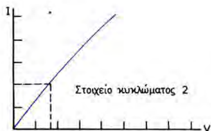
Σχήμα 12-11 Καμπύλες I-V για δυο στοιχεία κυκλώματος.
