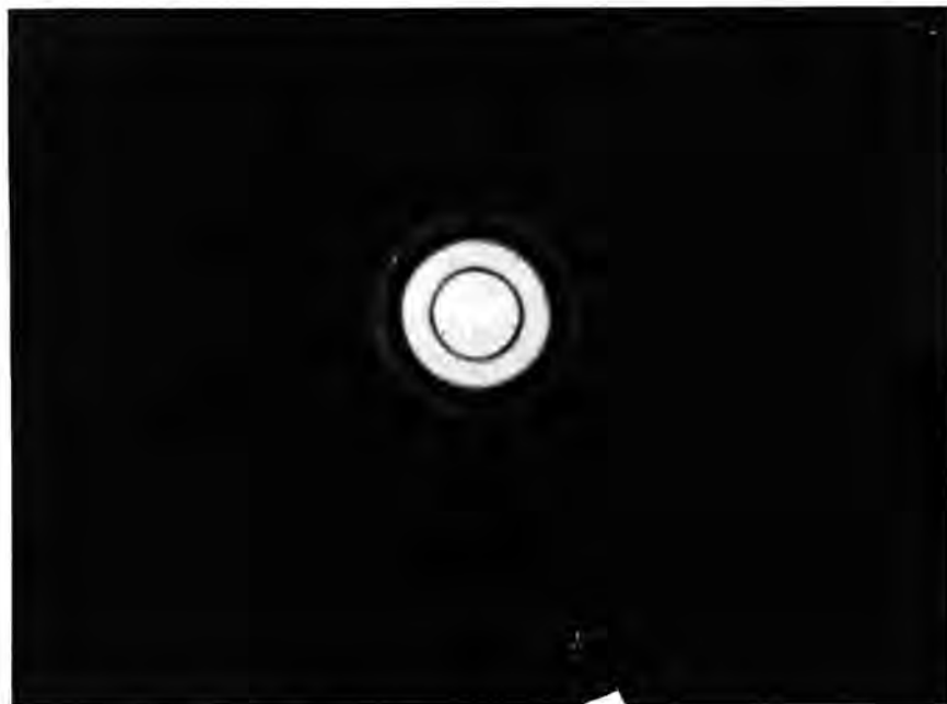
Σχήμα 18-28 Η εικόνα που δημιουργείται από μία λεπτή φωτεινή δέσμη που περνά μέσα από μία μικρή οπή με μέγεθος όσο το κεφάλι μιας καρφίτσας.
