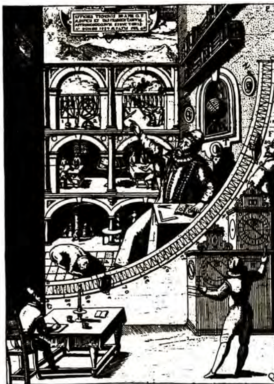
Σχήμα 5-15 Το επίτοιχο τεταρτοκύκλιο του Tycho Brahe. Στον τοίχο είχε στερεωθεί ένα μπρούντζινο τόξο ακτίνας μεγαλύτερης από 2 μέτρα, εφοδιασμένο με κινητές σκοπεύσεις. Ένας παρατηρητής (επάνω δεξιά) παρατηρούσε ένα άστρο μέσα από το παράθυρο στα αριστερά. Άλλοι δοηθοί σημείωναν το χρόνο και τη γωνία της παρατήρησης. Το τμήμα του τοίχου που περικλείεται από το τόξο καλύπτεται από μία τοιχογραφία που δείχνει τον Tycho και διάφορες σκηνές από τη δουλειά του.
