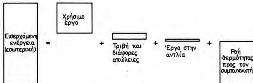
Σχήμα 10-9 Σχηματική απεικόνιση της μετατροπής ενέργειας σε ένα ατμοστρόβιλο.
