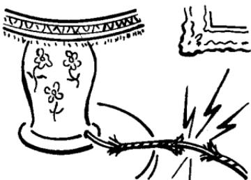
**Μη** χρησιμοποιήστε συσκευές μὲν φθαρμένα καλώδια. Ή μόνωση τῶν καλωδίων καταστρέφεται μὲ τήγα πάροδο τοῦ χρόνου καὶ τὰ καλώδια ἀπαιτοῦν ἀντικατάσταση.
