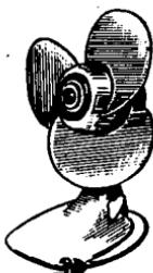
Σχ. 9·2 ε. Ἀνεμιστήρας ποὺ κινεῖται ἀπὸ μονοφασικὸ κινητήρα τύπου Γιουνιβέρσαλ.
