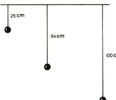
$l_2 = 64$  cm και  $l_3 = 100$  cm, μετρούμε τίς περιόδους τους, πού είναι:  $T_1 = 1$  s,  $T_2 = 1,6$  s και  $T_3 = 2$  s.
