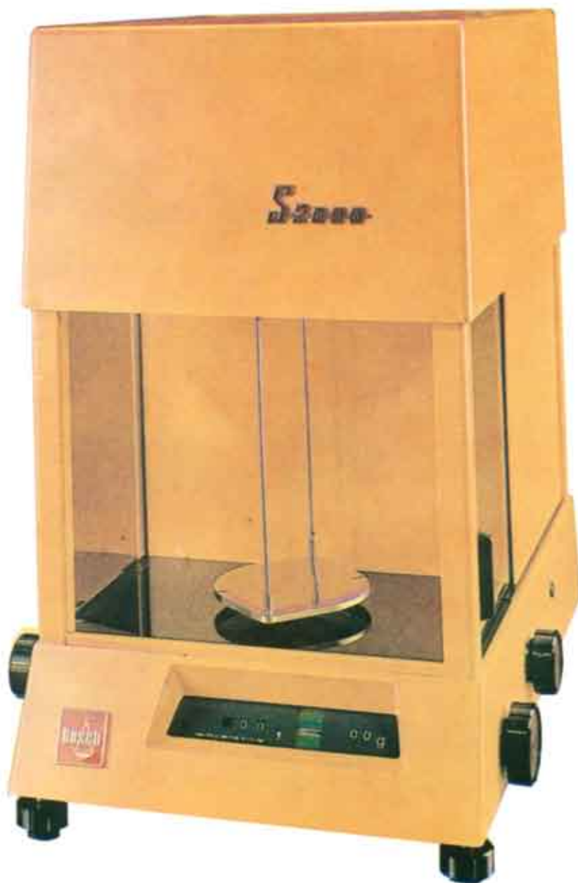
Σχ. 12.1γ. Ηλεκτρικός αναλυτικός ζυγός 0–200 g ( \pm 0,1 mg).
