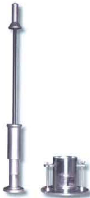
Σχ. 2.5. Μεταλλικός κύλινδρος (προσδιορισμός φαιν. ε.β.).
