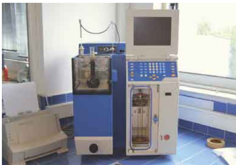
Σχ. 10.8α. Αυτόματη συσκευή αποστάξεως προϊόντων πετρελαίου.
