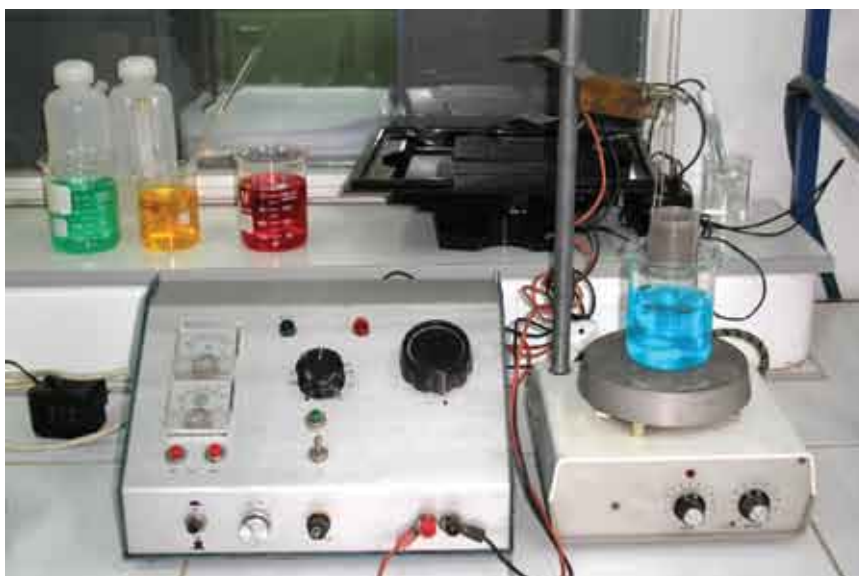
Σχ. 11.4. Συσκευή ηλεκτροανάλυσεως.
