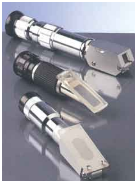
Σχ. 4.6β. Διαθλασίμετρο χειρός ή Μπριζδόμετρο.
