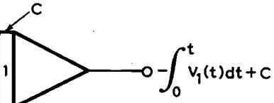
$v_1$ $\rightarrow$ $-\int_0^t v_1(t) dt + C$                | Ολοκληρωτής                                                               |
