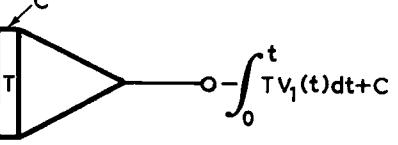
$v_1$ $\rightarrow$ $-\int_0^t T v_1(t) dt + C$              | Ολοκληρωτής με ενίσχυση                                                   |
