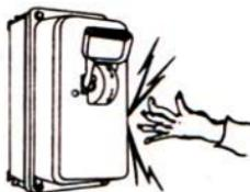
13. Πρὶν ἀπὸ κάθε χρῆσιν, πρέπει νὰ ἐλέγχωμεν μὲ προσοχὴν τὴν καλὴν λειτουργίαν καὶ μόνωσιν κάθε ἡλεκτρικῆς συσκευῆς ἢ μηχανήματος, τὰ δποῖα χρησιμοποιοῦνται σπανίως.
