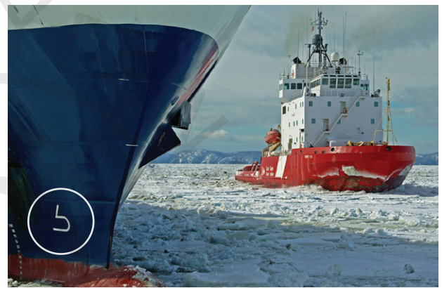
Σχ. 3.7 Ένδειξη για ύπαρξη βολβοειδούς πλώρης στα ύφαλα πλοίου
