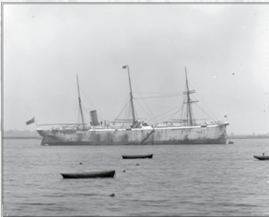
Το CS Hooper θεωρείται το πρώτο πλοίο ποντίσεως καλωδίων, κατασκευασμένο από την C. Mitchell & Co το 1873.
