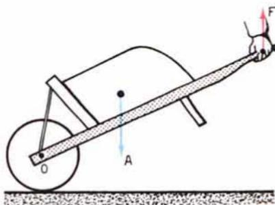
*Οί μοχλοί, στους οποίους το σημείο, όπου εφαρμόζεται ή δύναμι, εύρισκεται μεταξύ του υπομοχλίου και του σημείου, όπου εφαρμόζεται ή αντίστασι, ονομάζονται μοχλοί τρίτου είδους.*
