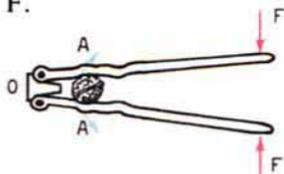
*Οί μοχλοί, στους οποίους το σημείο, όπου εφαρμόζεται ή αντίστασι, εύρισκεται μεταξύ του υπομοχλίου και του σημείου, όπου εφαρμόζεται ή δύναμι, ονομάζονται μοχλοί δευτέρου είδους.*
