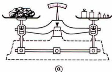
Στόν ζυγό με ίσους βραχίονες και στόν ζυγό του Roberval μπορούμε να αντιμεταθέσωμε τὰ βάρη τῶν δίσκων, χωρίς νὰ καταστραφῆ ἡ ἰσορροπία.
