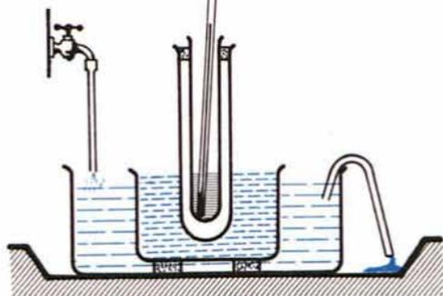
Ἀρχικῶς δηλαδή ἡ θερμοκρασία θὰ κατεβαίνει μέχρι τοῦς  $80^{\circ}\text{C}$ , ὅποτε θὰ ἀρχίσῃ ἡ στερεοποίηση τῆς ναφθαλίνης. Καθ' ὅλη τὴν διάρκεια τῆς στερεοποιήσεως, τὸ θερμομετρο θὰ μᾶς δείχνῃ σταθερὰ  $80^{\circ}\text{C}$ .
