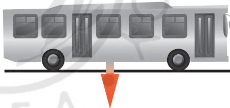
**Σχήμα 2.26** Δύναμη βάρους σε επίπεδη επιφάνεια.
