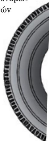
βάθος πέλματος των ελαστικών με χειμερινό πέλμα είναι 4,0 mm. Τα ελαστικά των λεωφορείων είναι τύπου R (Radial-ακτινωτά) και TUBELLES (χωρίς αεροθάλαμο). Τα δίδυμα ελαστικά δέχονται μέγιστη φόρτωση 7750 kg. Υπερφόρτωση κατά 20% μειώνει την αντοχή του ελαστικού κατά 30% και ελαττώνει την αποτελεσματικότητα της πέδησης.
