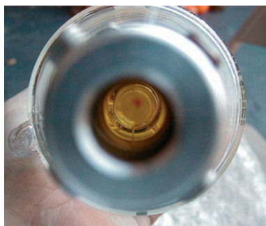
Εικόνα 2.15 Το άκρο εξόδου της δέσμης Λείζερ από μια συσκευή Λείζερ \text{CO}_2 .
