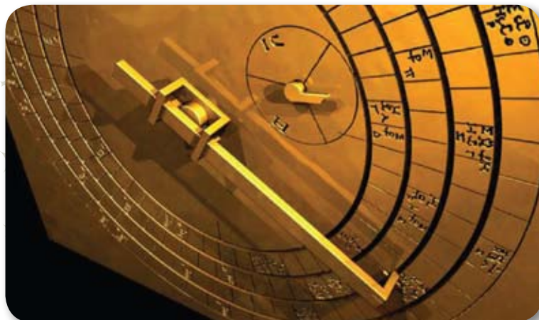
Ψηφιακή ανακατασκευή του δείκτη με τη βοήθεια του οποίου υπολογίζονταν οι εκλείψεις, με βάση τη περίοδο του Σάρου (© 2008 Tony Freeth / Antikythera Mechanism Research Project).
