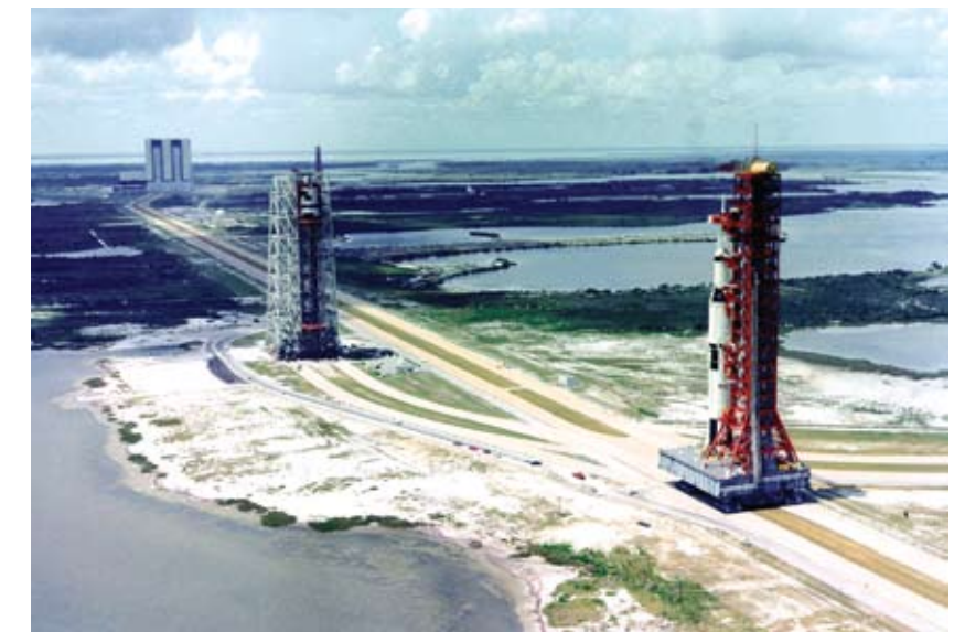
Ερπυστριοφόρο όχημα μεταφέρει τη διαστημοσυσκευή Apollo προς τη βάση εκτόξευσης.
