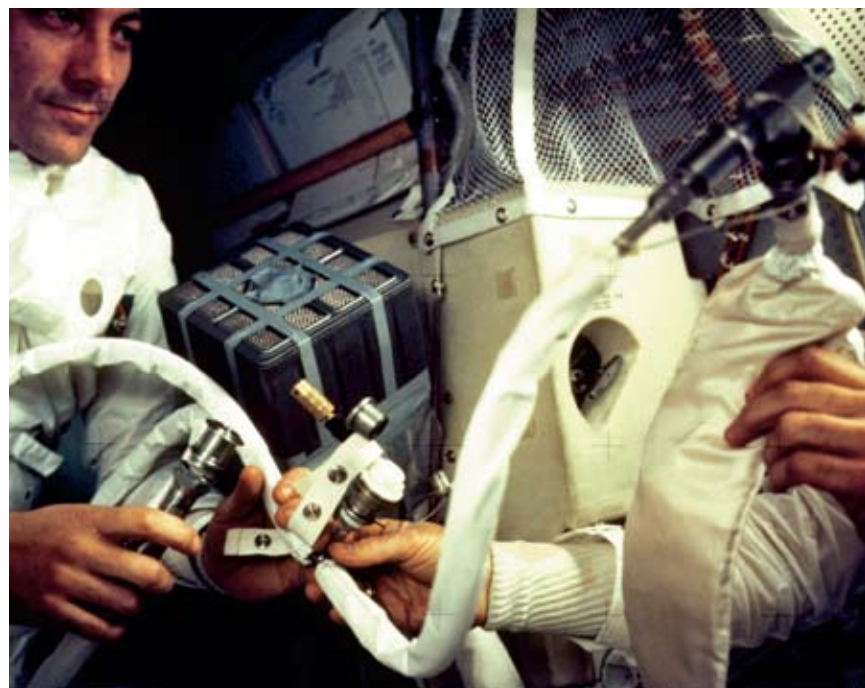
Με τη βοήθεια του προσωπικού του κέντρου ελέγχου στη Γη, οι αστροναύτες του Apollo 13 κατάφεραν να συνδέσουν δύο συστήματα φίλτρων και να καθαρίσουν τον αέρα στο σκάφος από το διοξείδιο του άνθρακα.
