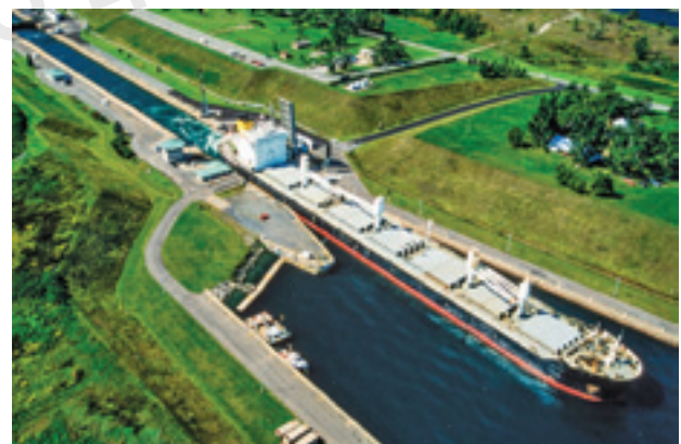
Σχ. 22.3 Πλοίο τύπου Seawaymax ή salty ship εξέρχεται από λεκάνη του Seaway
