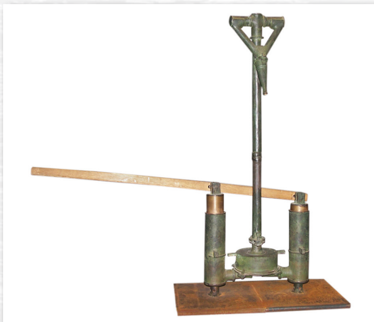
Εμβολοφόρος αντλία του Κτησιβίου (285-222 π.Χ.), Έλληνα μαθηματικού, μηχανικού, εφευρέτη και ιδρυτή της Σχολής Μηχανικών και Μαθηματικών στην Αλεξάνδρεια.
