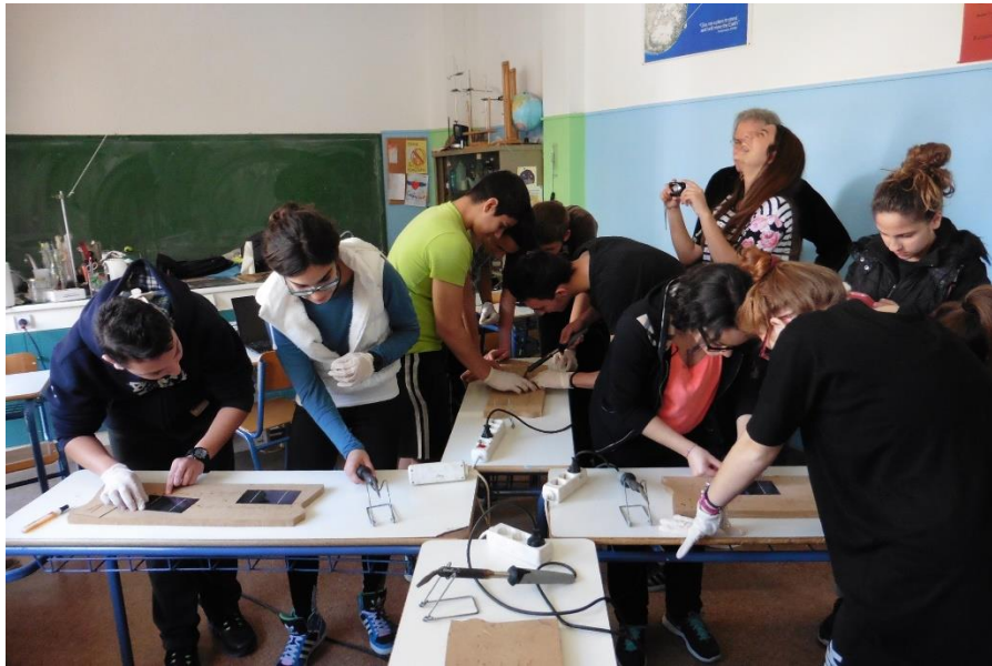
Εικόνα 15. Κόλληση χαλκοταινιών στις κυψέλες δουλεύοντας σε ομάδες με διάταξη θρανίων σε σχήμα σταυρού.
