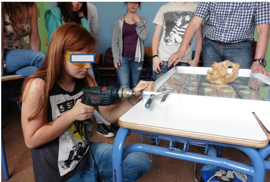
Εικόνα 22. Χρήση δραπενου για τοποθέτηση του πάνελ αλουμινίου.
