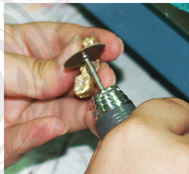
Σχ. 8.6 Με τα κατάλληλα εργαλεία λειαίνουμε τις επιφάνειες των δοντιών.
