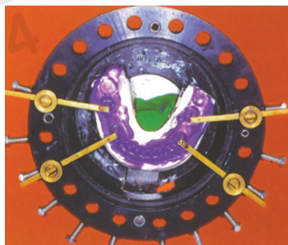
Σχ. 1.9 Τοποθέτηση καρφίδας σε κολόβωμα τελικού αποτυπώματος (α) με το χέρι, (β) με τη βοήθεια παραλληλιστή.
