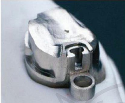
Σχ. 16.5 Εξωκορωνικός χυτευόμενος σύνδεσμος ακριβείας.
