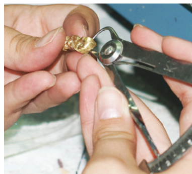
Σχ. 8.7 Ο συνεχής έλεγχος του χυτού με παχύμετρο συμβάλλει στην αποφυγή πιθανής βλάβης.
