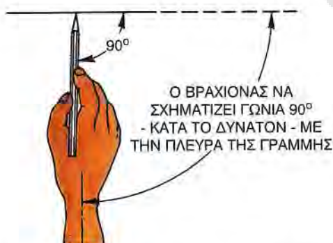
ΣΧΗΜΑ 8.2. Το σχέδιο αυτό δείχνει τις κατάλληλες θέσεις του χεριού και του μολυβιού για τη χαράξη οριζοντίων γραμμών.
