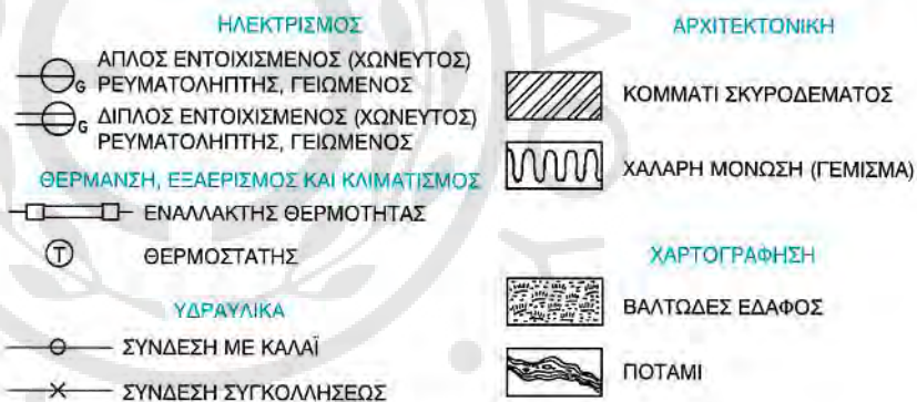
ΣΧΗΜΑ 8.27. Εδώ παρουσιάζονται ορισμένα παραδείγματα σχεδιαστικών συμβόλων, που χρησιμοποιούνται σε διάφορους τομείς.
