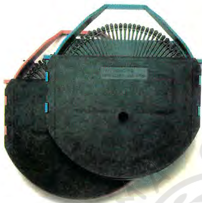
ΣΧΗΜΑ 5.15. Σε έναν εκτυπωτή τύπου περιστρεφόμενης μαργαρίτας, κάθε χαρακτήρας βροίσκεται σε μια διαφορετική ακτίνα της περιστρεφόμενης κεφαλής εκτυπώσεως.
