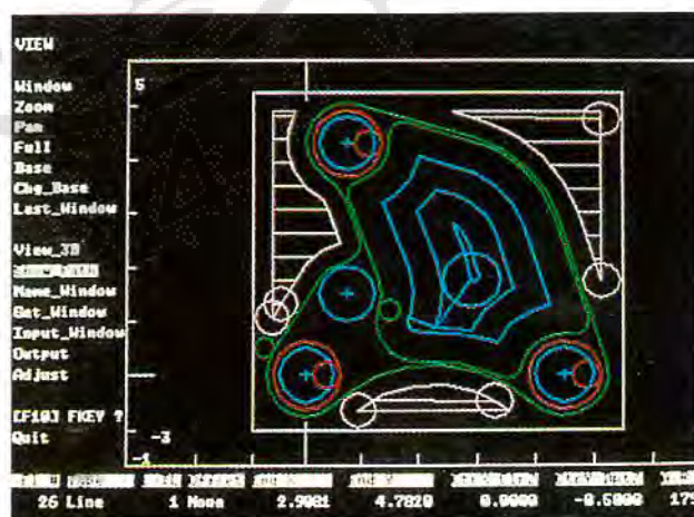
ΣΧΗΜΑ 9.11. Στο σύστημα CAD/CAM, το εξάρτημα σχεδιάζεται σε ένα σύστημα CAD, φορτώνεται σε ένα σύστημα CAM και κατασκευάζεται από ένα εργαλείο που ελέγχεται από έναν υπολογιστή αριθμητικού ελέγχου (CNC). Στο σύστημα CAM εικονίζεται η άρθρωση αεροπλάνου από το σχήμα 9.8.
