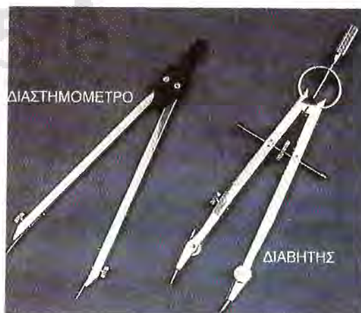
ΣΧΗΜΑ 7.28. Τα διαστημόμετρα (αριστερά) και οι διαβήτες (δεξιά) είναι βασικά όργανα για σχεδίαση. Ένας διαβήτης φέρει μολύβι σχεδίασεως. Το διαστημόμετρο όχι.
