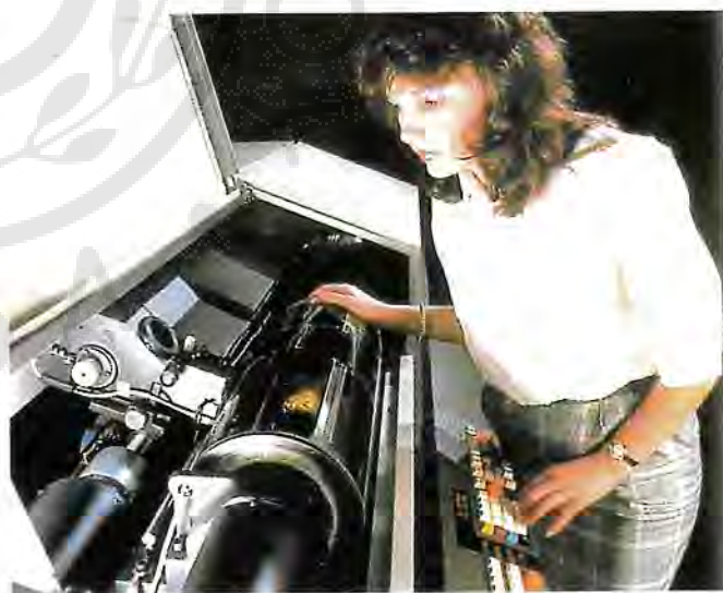
ΣΧΗΜΑ 5.11. Ο σαρωτής στέλνει μία εικόνα στον υπολογιστή. Ο σαρωτής επάνω συνδέθηκε με έναν προσωπικό υπολογιστή για εισαγωγή κειμένου και γραφημάτων. Τέτοιοι σαρωτές χρησιμοποιούνται ευρέως για επιτραπέζιες εκδόσεις. Κάτω εικονίζεται ένας σαρωτής τυμπάνου, που χρησιμοποιείται από τις εταιρείες γραφικών τεχνών για σάρωση έγχρωμου καλλιτεχνικού έργου.
