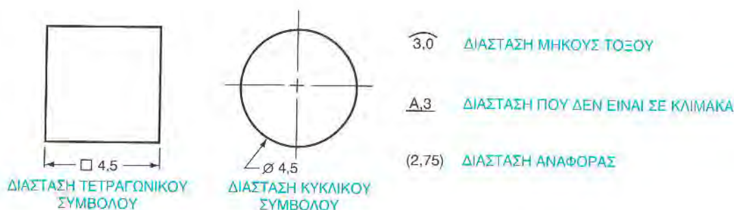
ΣΧΗΜΑ 7.12. Αυτά είναι ορισμένα από τα σύμβολα που χρησιμοποιούνται για να δηλωθούν σχήματα και συνθήκες.
