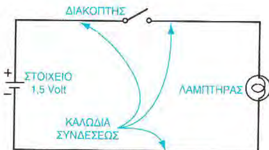
ΣΧΗΜΑ 8.34. Ένα σχηματικό διάγραμμα έχει σύμβολα που δείχνουν πώς συνδέονται τα κομμάτια. Σύγκρινε το διάγραμμα αυτό με το διάγραμμα καλωδιώσεως στο σχήμα 8.33.
