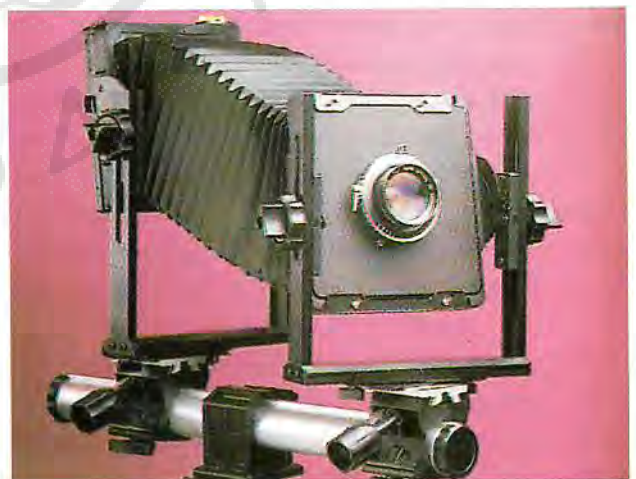
ΣΧΗΜΑ 11.8. Οι φωτογραφικές μηχανές απ' ευθείας σκοπεύσεως χρησιμοποιούν πολύ μεγάλα φύλλα φιλμ, για να πάρουν φωτογραφίες υψηλής ποιότητας. Τόσο ο φακός όσο και το φιλμ, μπορούν να αλλάζουν κλίσεις για να διαμορφωθεί ανάλογα η προοπτική της φωτογραφίας.
