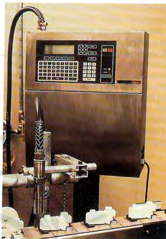
ΣΧΗΜΑ 15.26. Αυτός ο εκτυπωτής οπτικού ψεκασμού τυπώνει κώδικες σε φυσίγγια που χρησιμοποιούνται σε ιατρικές εξετάσεις.
