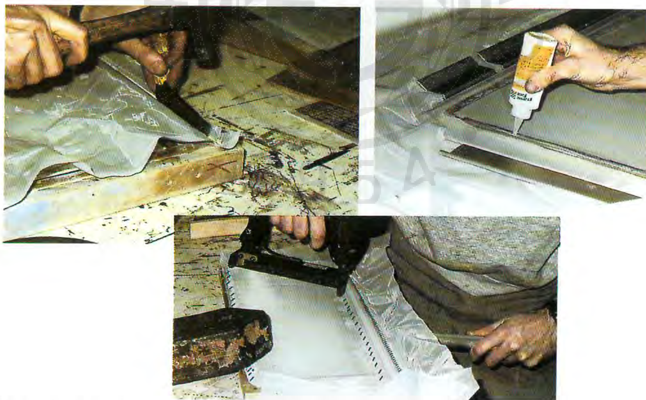
ΣΧΗΜΑ 15.18. Τρεις είναι κυρίως οι τρόποι για την προσαρμογή της σίτας στο ξύλινο πλαίσιο: με κορδόνη και υποδοχές (αριστερά), με επικόλληση (δεξιά) και με άγκιστρα (κάτω).
