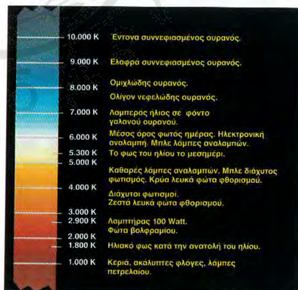
ΣΧΗΜΑ 10.11. Κάθε πηγή φωτός εκπέμπει διαφορετικό φως και θερμοκρασία.
