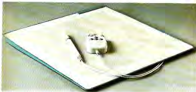
ΣΧΗΜΑ 5.4. Αυτή η ταμπλέτα ψηφιοποίησης είναι εφοδιασμένη με μια ακίδα και ένα πακ.
