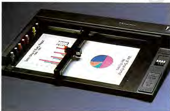
ΣΧΗΜΑ 9.3. Οι οριζόντιοι σχεδιογράφοι (αριστερά) συνήθως μπορούν να τοποθετηθούν στην επιφάνεια ενός γραφείου. Οι σχεδιογράφοι τυμπάνου (δεξιά) στηρίζονται στο πάτωμα.
