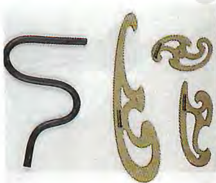
ΣΧΗΜΑ 7.26. Στα αριστερά παρουσιάζονται ένα εύκαμπτο και τρία γαλλικά καμπυλόγραμμα. Στα δεξιά εικονίζεται ένα σύνολο κυκλικών καμπυλογράμμων.
