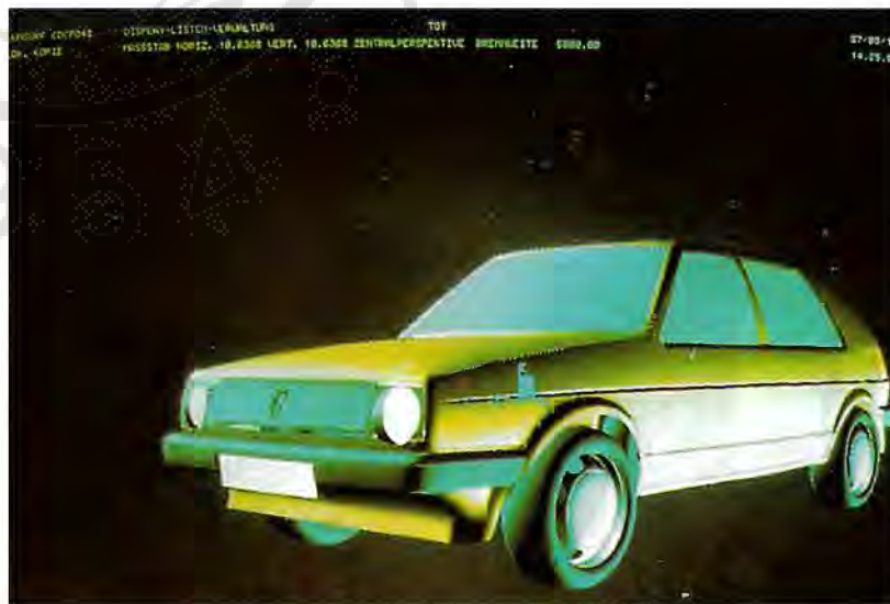
ΣΧΗΜΑ 9.9. Ένα υπόδειγμα επιφάνειας μοιάζει να είναι πιο πραγματικό συγκριτικά με ένα υπόδειγμα συρμάτινου σκελετού.
