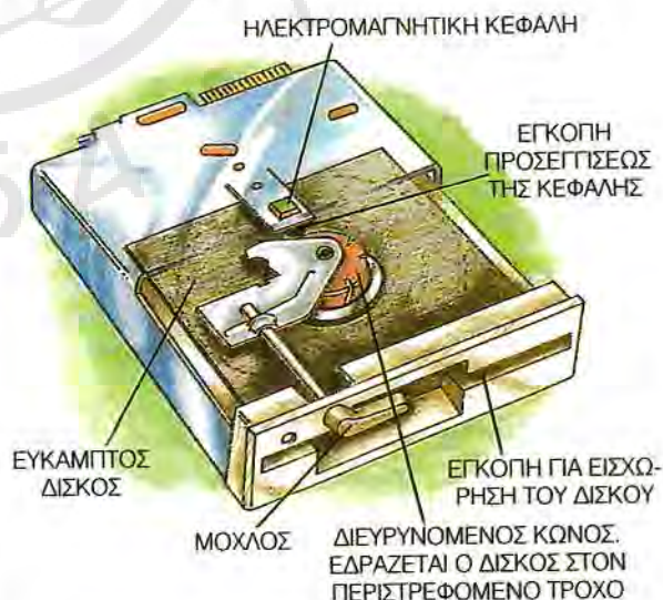
ΣΧΗΜΑ 5.18. Η ηλεκτρομαγνητική κεφαλή αναγνώσεως και γραφής κινείται εμπρός-πίσω επάνω από τον εύκαμπτο δίσκο.
