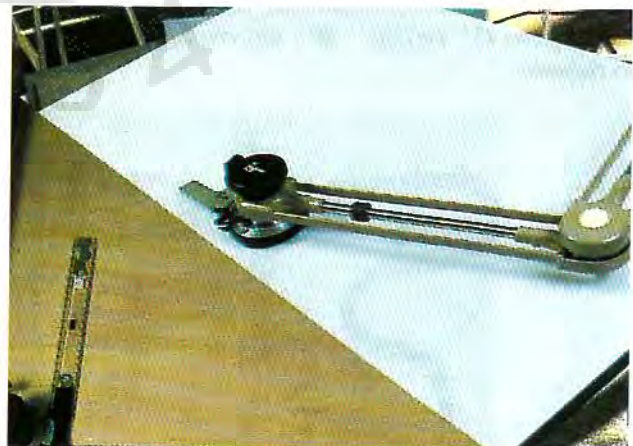
ΣΧΗΜΑ 7.23. Μηχανισμοί σχεδίασεως, όπως αυτοί, βοηθούν τους σχεδιαστές στη χάραξη οριζοντίων, καθέτων και κεκλιμένων γραμμών.
