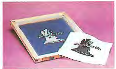
ΣΧΗΜΑ 15.17. Οδηγοί κομμένοι με το χέρι (αριστερά), έμμεση φωτογράφιση (κέντρο) και άμεση φωτογράφιση (δεξιά) χρησιμοποιούνται για την παραγωγή μεταξοτυπίας.
