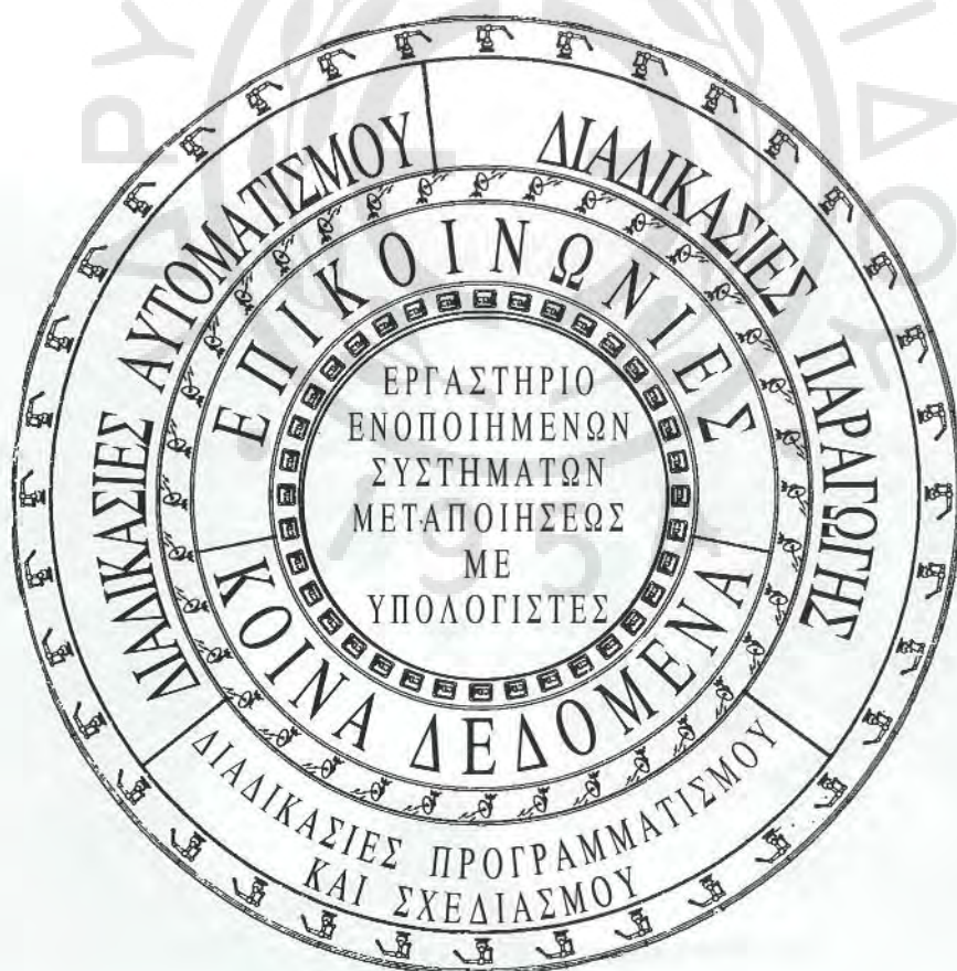
ΣΧΗΜΑ 2.9. Σε ένα ενοποιημένο σύστημα μεταποίησης με υπολογιστές (CIM System), όλες οι παράμετροι για τη λειτουργία της μεταποιητικής διαδικασίας συνδέονται με υπολογιστές.
