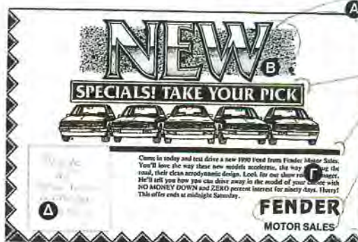
ΣΧΗΜΑ 13.21. Ταινία περιθωρίου, “περιοκοπτόμενη τέχνη”, στοιχειοθετημένο αντίγραφο, παράθυρο απαλού (μισού) τόνου και μη αναπαραγόμενες μπλε γραμμές, όλα αυτά έχουν χρησιμοποιηθεί για να παραχθεί αυτό το μηχανικό.
