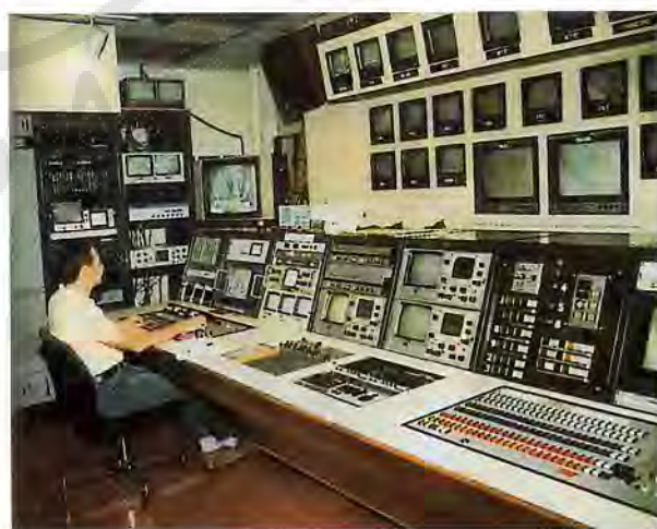
ΣΧΗΜΑ 17.23. Ο σκηνοθέτης κάθεται στο μεταγωγέα εικόνων και μπορεί να βλέπει τις εικόνες που μεταδίδονται από κάθε συσκευή λήψεως. Η μεταγωγή από τη μία στην άλλη μπορεί να γίνει εύκολα.
