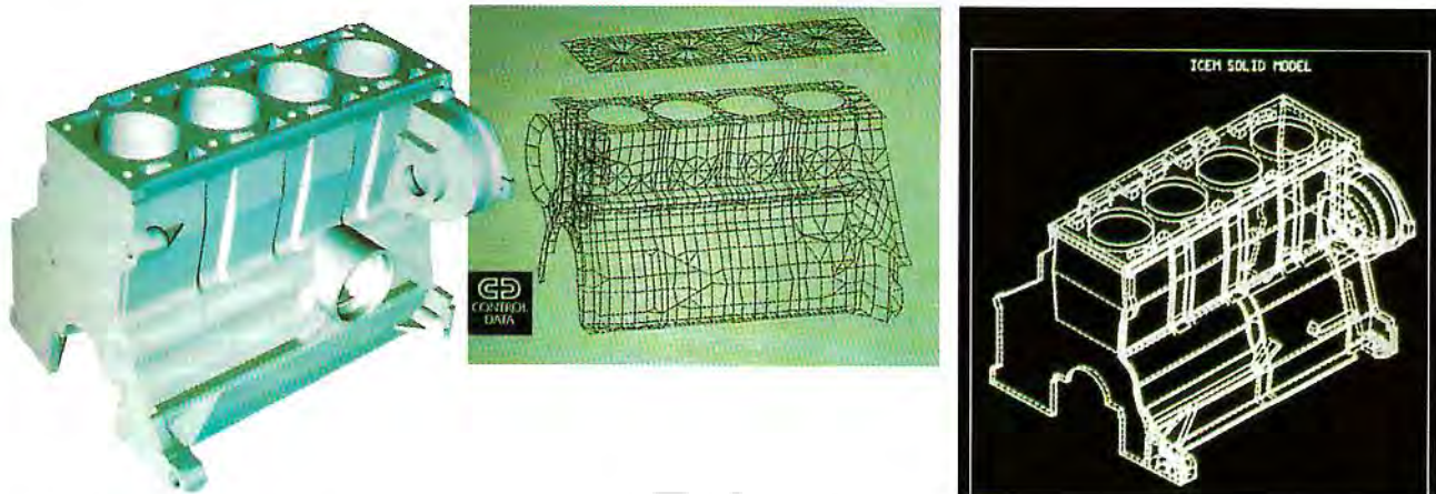
ΣΧΗΜΑ 9.12. Εδώ εικονίζονται γραφικά που παρήχθησαν από το σύστημα ICEM. Έχουμε (από αριστερά προς τα δεξιά) ένα πλήρες υπόδειγμα μιας μηχανής αυτοκινητό, ένα πλέγμα πεπερασμένων στοιχείων που έχει παραχθεί από το πλήρες υπόδειγμα και χρησιμοποιείται για δομική ανάλυση της κατασκευής και ένα υπόδειγμα επιφάνειας που χρησιμοποιείται για να παραχθούν ταινίες αριθμητικού ελέγχου.
