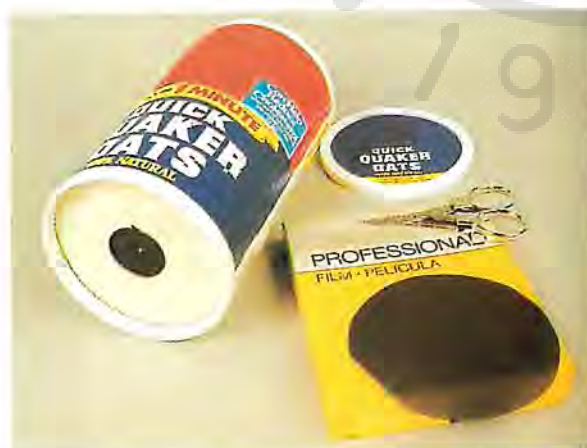
ΣΧΗΜΑ 11.2. Η απλή φωτογραφική μηχανή που εικονίζεται αριστερά είναι ένα φωτοστεγές “κουτί” με μια οπή σε μέγεθος καρφίτσας στο ένα άκρο. Το άλλο άκρο ανοίγει, ώστε να μπορεί να προσαρμοσθεί εσωτερικά φιλμ (η βασική δραστηριότητα #2 στο τέλος της ενότητας IV σου λέει πώς να κατασκευάσεις μια τέτοια φωτογραφική μηχανή). Δεξιά εικονίζεται μια πιο σύνθετη φωτογραφική μηχανή.
