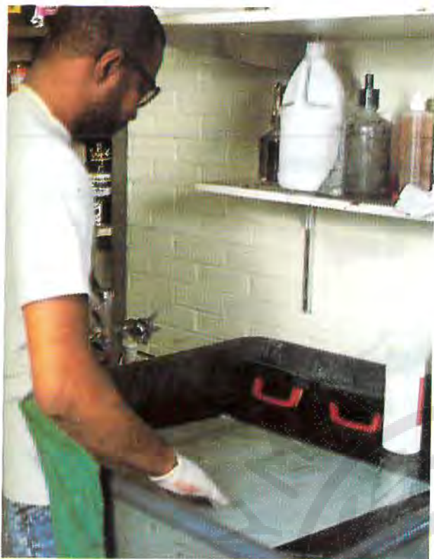
ΣΧΗΜΑ 15.3. Η εμφάνιση της πλάκας είναι όμοια με την εμφάνιση του φιλμ. Οι μέθοδοι ποικίλλουν ανάλογα με τον τύπο της πλάκας. Εδώ, για ένα μικρό έργο, η εμφάνιση γίνεται με το χέρι.
