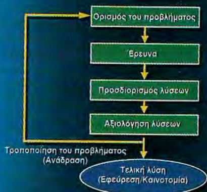
ΣΧΗΜΑ 1.10. Επάνω: Όταν αναπτύσσουν νέες τεχνολογίες οι εφευρέτες, χρησιμοποιούν τη μέθοδο επιλύσεως προβλημάτων. Δεξιά: Ο Philo T. Farnsworth, ένας από τους εφευρέτες της τηλεοράσεως, είχε επιδείξει αυτή τη συσκευή λήψεως εικόνων στους δημοσιογράφους το 1935.
