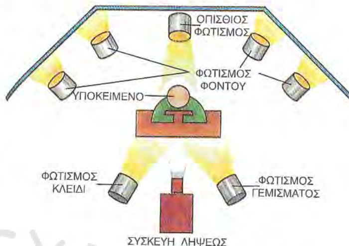
ΣΧΗΜΑ 18.17. Αυτή η διάταξη φωτισμού συνηθίζεται να χρησιμοποιείται σε πολλά ζωντανά τηλεοπτικά προγράμματα.
