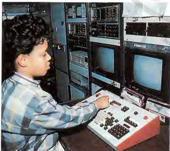
ΣΧΗΜΑ 17.24. Τίτλοι και κατάλογοι ανθρώπων που εργάστηκαν για ένα πρόγραμμα παράγονται στη γεννήτρια χαρακτήρων.
