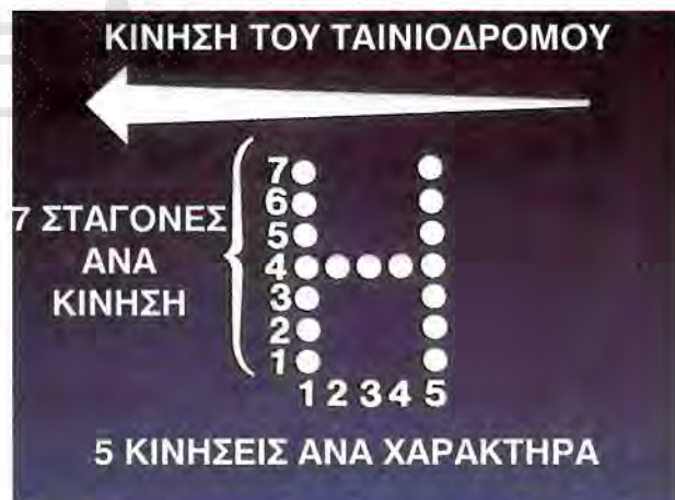
ΣΧΗΜΑ 15.24. Αριστερά το διάγραμμα παρουσιάζει την εκτύπωση με ψεκασμό μελάνης συνεχούς ροής. Δεξιά φαίνεται πώς σχηματίζεται κάθε χαρακτήρας σε διαδοχικές κάθετες σαρώσεις.
