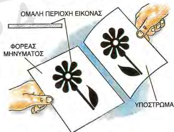
ΣΧΗΜΑ 15.2. Το σχέδιο αυτό παρουσιάζει την αρχή της λιθογραφίας. Επειδή η εκτύπωση γίνεται από μία επίπεδη επιφάνεια, η λιθογραφία είναι μία πλανογραφική διαδικασία εκτυπώσεως.
