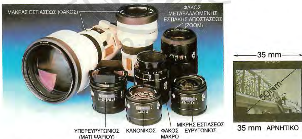
ΣΧΗΜΑ 11.14. Εδώ εικονίζονται διάφορα είδη φακών που μπορεί να έχει ένας επαγγελματίας φωτογράφος ή ένας απαιτητικός ερασιτέχνης. Δεξιά. Ένας κανονικός φακός έχει εστιακή απόσταση περίπου ίση με τη διαγώνιο του αρνητικού φιλμ.
