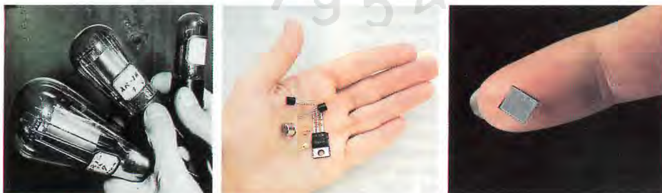
ΣΧΗΜΑ 4.6. Τα τρανζίστορ ήταν πολύ μικρότερα από τις λυχνίες κενού, αλλά τα ολοκληρωμένα κυκλώματα (τσιπς) των υπολογιστών είναι ακόμη μικρότερα. Τα ολοκληρωμένα κυκλώματα περιλαμβάνουν τώρα περισσότερα από ένα εκατομμύριο ηλεκτρονικά στοιχεία σε ένα απλό ολοκληρωμένο κύκλωμα πυριτίου.
