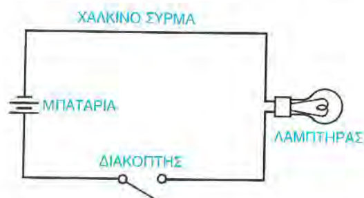
ΣΧΗΜΑ 16.3. Το διάγραμμα αυτό δείχνει την πορεία που ακολουθούν τα ηλεκτρόνια σε ένα απλό κύκλωμα φακού.
