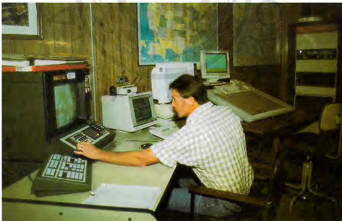
ΣΧΗΜΑ 2.10. Οι υπολογιστές χρησιμοποιούνται κατά κόρον στις γραφικές τέχνες και την εκδοτική διαδικασία. Εδώ παρουσιάζεται ένα σύστημα σελιδοποίησης που επιτρέπει στο χρήστη να σελιδοποιεί εικόνες ηλεκτρονικά.
