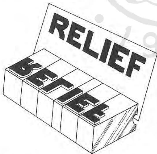
ΣΧΗΜΑ 15.7. Εδώ εικονίζεται μία ανάγλυφη εκτύπωση. Παρατήρησε ότι τα γράμματα (περιοχή της εικόνας) είναι ανυψωμένα.
