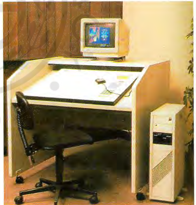
ΣΧΗΜΑ 14.15. Τα συστήματα αυτόματης αφαιρέσεως μπορούν να εκθέσουν στο φως ένα σύνολο από αρνητικά που βρίσκονται στην κατάλληλη θέση, εγκάρσια σε μία φωτογραφική πλάκα. Τα συστήματα αυτά παρακάμπτουν τη διαδικασία κατασκευής ενός φύλλου συναρμόσεως.
