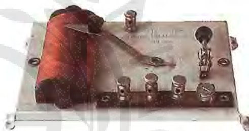
ΣΧΗΜΑ 17.7. Το πρώτο ραδιόφωνο ονομαζόταν “συσκευή κρυστάλλου”. Χρησιμοποιούσε έναν πιεζοηλεκτρικό κρύσταλλο. Οι πιεζοηλεκτρικοί κρύσταλλοι παράγουν μία μικρή τάση, όταν εφαρμόζεται σε αυτούς μία πίεση.
