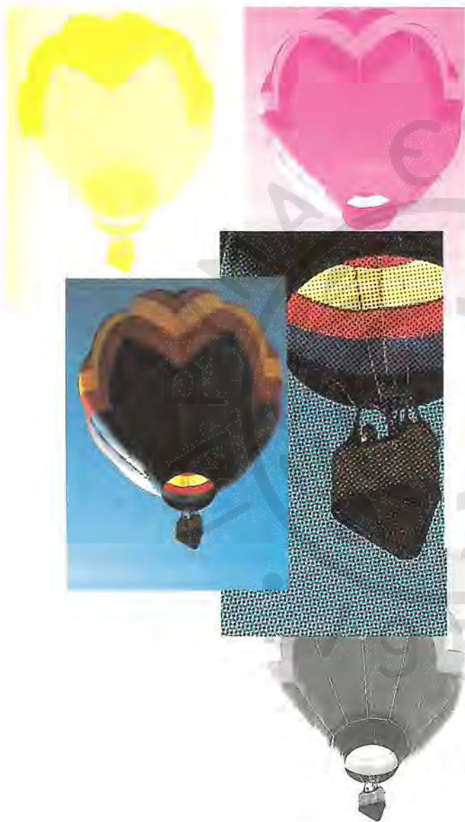
ΣΧΗΜΑ 14.9. Μία έγχρωμη φωτογραφία μπορεί να διαχωρισθεί σε τέσσερα αφαιρετικά χρώματα: κίτρινο, πορφυρό, κυανό και μαύρο. Όταν τυπώνονται ως απαλοί τόνοι, το ένα επάνω στο άλλο, οι διαχωρισμοί αυτοί δημιουργούν την οφθαλμαπάτη μίας τελείως έγχρωμης εικόνας. Πρόσεξε το σχηματισμό στιγμών που εικονίζεται δεξιά.
