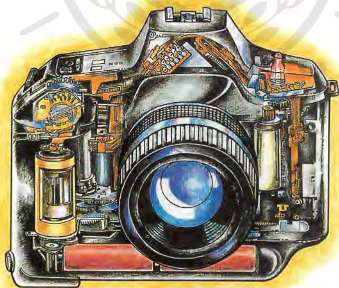
ΣΧΗΜΑ 2.2. Πολλές μηχανές λήψεως εικόνας διαθέτουν ολοκληρωμένα κυκλώματα (chips) για να ελέγχουν την εστίαση και το διάφραγμα.
