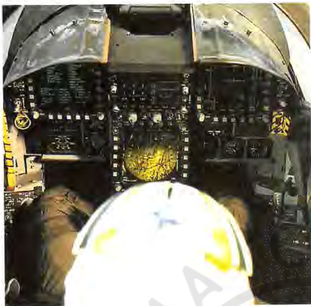
ΣΧΗΜΑ 18.7. Η μικρή οθόνη ακριβώς επάνω από το κεφάλι του πιλότου είναι για το ραντάρ. Το ανακλώμενο σήμα του ραντάρ φαίνεται επάνω στην οθόνη.
