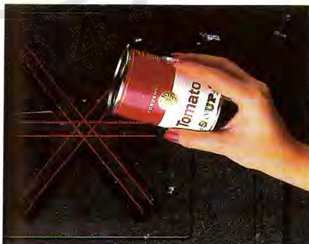
ΣΧΗΜΑ 6.13. Ο σαρώτης “διαβάζει” τον κώδικα ραβδώσεων και στέλνει τις σχετικές πληροφορίες στον υπολογιστή.
