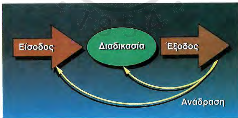
ΣΧΗΜΑ 1.1. Το καθολικό υπόδειγμα συστημάτων περιγράφει συστήματα με όρους όπως είσοδος, διαδικασία, έξοδος και ανάδραση.
