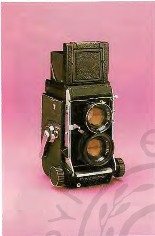
ΣΧΗΜΑ 11.6. Οι διοπτικές ρεφλέξ φωτογραφικές μηχανές (TLR) έχουν δύο φακούς. Ο άνω φακός είναι για να βλέπομε το αντικείμενο. Ο κάτω φακός χρησιμοποιείται για να φωτογραφίζομε.
