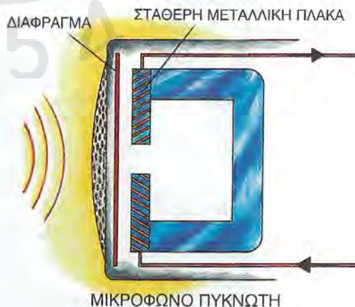
ΣΧΗΜΑ 17.8. Ένα μικρόφωνο πυκνωτή διαθέτει μία σταθερή μεταλλική πλάκα, για να δημιουργεί μεταβαλλόμενη τάση για το σήμα.
