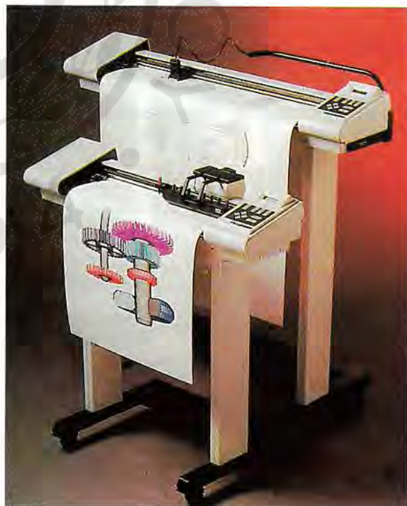
ΣΧΗΜΑ 9.3. Οι οριζόντιοι σχεδιογράφοι (αριστερά) συνήθως μπορούν να τοποθετηθούν στην επιφάνεια ενός γραφείου. Οι σχεδιογράφοι τυμπάνου (δεξιά) στηρίζονται στο πάτωμα.
