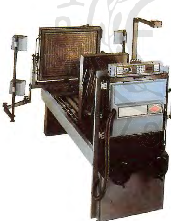
ΣΧΗΜΑ 14.1. Αυτή η φωτογραφική μηχανή οριζόντιας επεξεργασίας θα εγκατασταθεί κατά τρόπο ώστε το πίσω μέρος να είναι στο σκοτεινό δωμάτιο και το εμπρόσθιο (με πίνακα αντιγραφής και φώτα) να είναι σε ένα φωτισμένο δωμάτιο.
