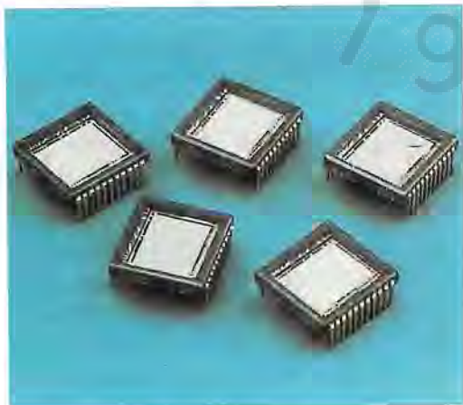
ΣΧΗΜΑ 17.21. Οι διατάξεις με σύζευξη φορτίου χρησιμοποιούνται στη θέση των λυχνιών λήψεως στις βιντεοκάμερες.
