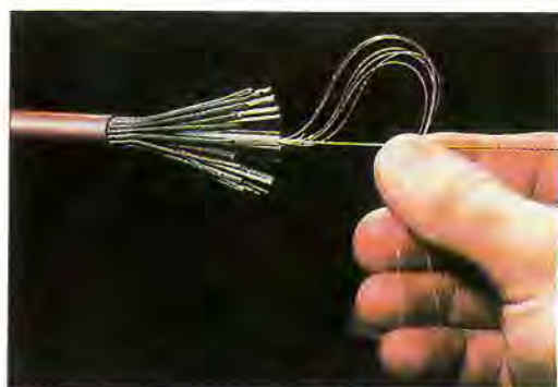
ΣΧΗΜΑ 10.27. Οι οπτικές ίνες είναι ειδικά κατασκευασμένα λεπτά νήματα γυαλιού που μεταδίδουν φως.
