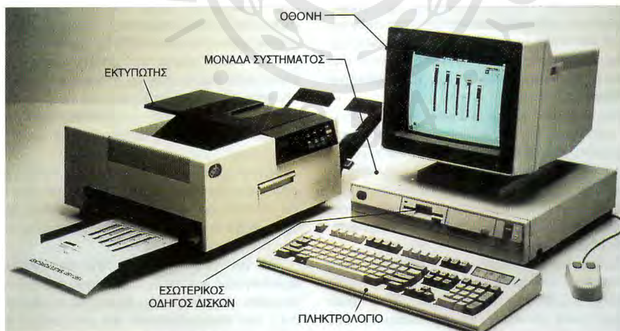
ΣΧΗΜΑ 4.14. Ένας τυπικός υπολογιστής περιλαμβάνει τα εξαρτήματα που παρουσιάζονται εδώ. Η μονάδα του συστήματος “στεγάζει” τον μικροεπεξεργαστή, τη μνήμη και τους οδηγούς δίσκων.
