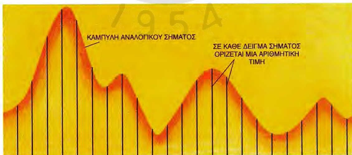
ΣΧΗΜΑ 6.1. Ένας μετατροπέας από το αναλογικό στο ψηφιακό σύστημα, κάνει αναγνώσεις των αναλογικών συστημάτων και ορίζει έναν αριθμό σε κάθε ανάγνωση. Όσο υψηλότερη είναι η τάση του ρεύματος, τόσο μεγαλύτερος είναι ο αριθμός.
