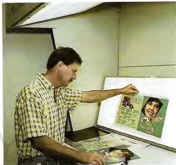
ΣΧΗΜΑ 10.12. Το εκτυπωμένο αντίγραφο συγκρίνεται με το πρωτότυπο μέσα σε ένα θάλαμο ελέγχου χρωμάτων με φωτισμό 5000 K.
