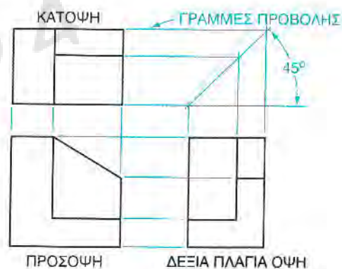
ΣΧΗΜΑ 8.14. Η πρόσοψη σχεδιάζεται συνήθως πρώτα. Κατόπιν σχεδιάζονται γραμμές προβολής προς τα έξω ξεκινώντας από την πρόσοψη. Στο τέλος σχεδιάζονται οι άλλες όψεις.
