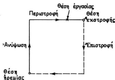
Σχ. 16.1θ. 100/μερής έπαφική ξδρα καί κινήσεις τών βραχιόνων του ύψοστροφικού επιλογέα.
